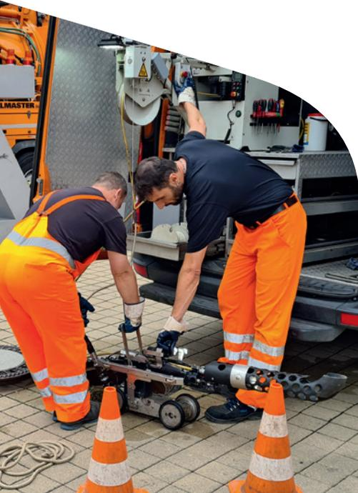
**Kameras mit einem Joystick durch Kanäle steuern. Was nach einem Computerspiel klingt, ist in Wirklichkeit eine wichtige Maßnahme zur sicheren Betriebsführung des Chemnitzer Abwassernetzes.**
